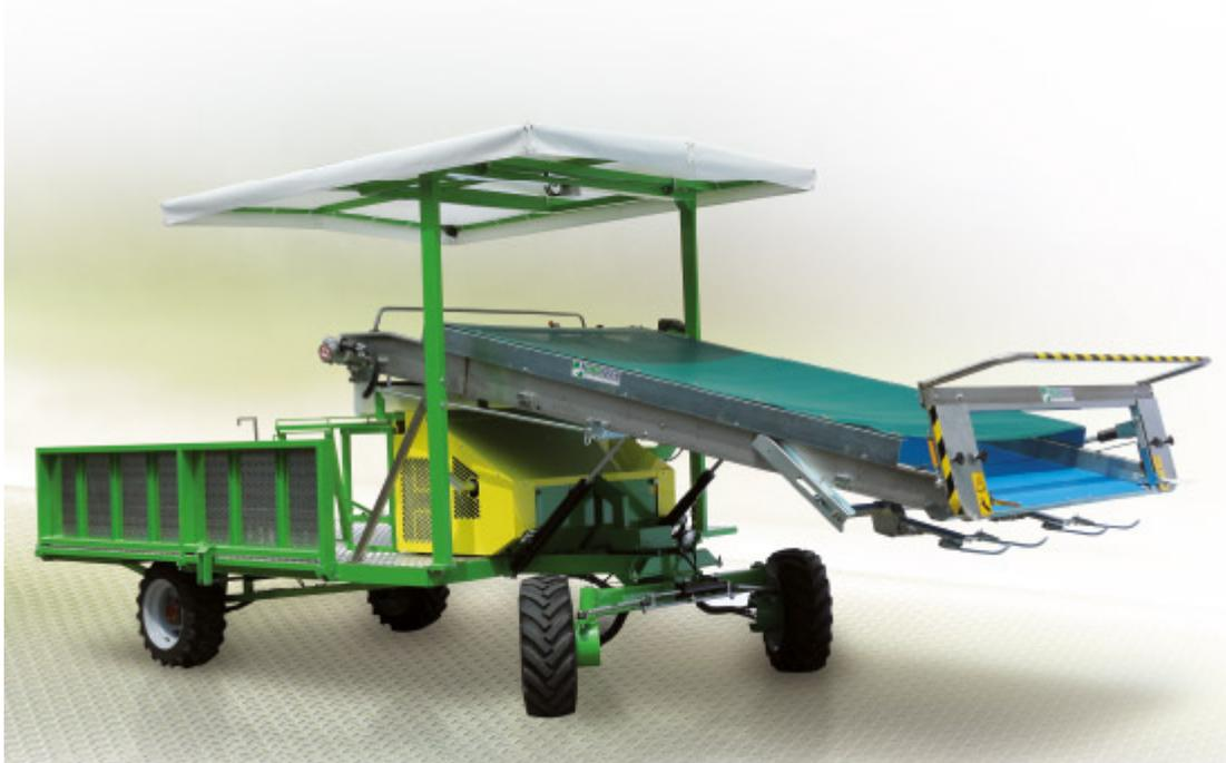
SLIDE CRAB ist die perfekte Erntemaschine für die Ernte der Baby-leaf Salat, Rucola, Spinat und alle Produkte, die in den Gewächshäusern oder im Feld wachsen. SLIDE CRAB mit der Stärke ihrer Struktur hat eine Ladungsfähigkeit von etwa 1000 - 1200 Kg. Die innovativste Kennzeichen sind das hydraulische System der neuesten Generation und die Lenkung der vorderen Achse, die die Bewegung verbessert und bequemer macht.
