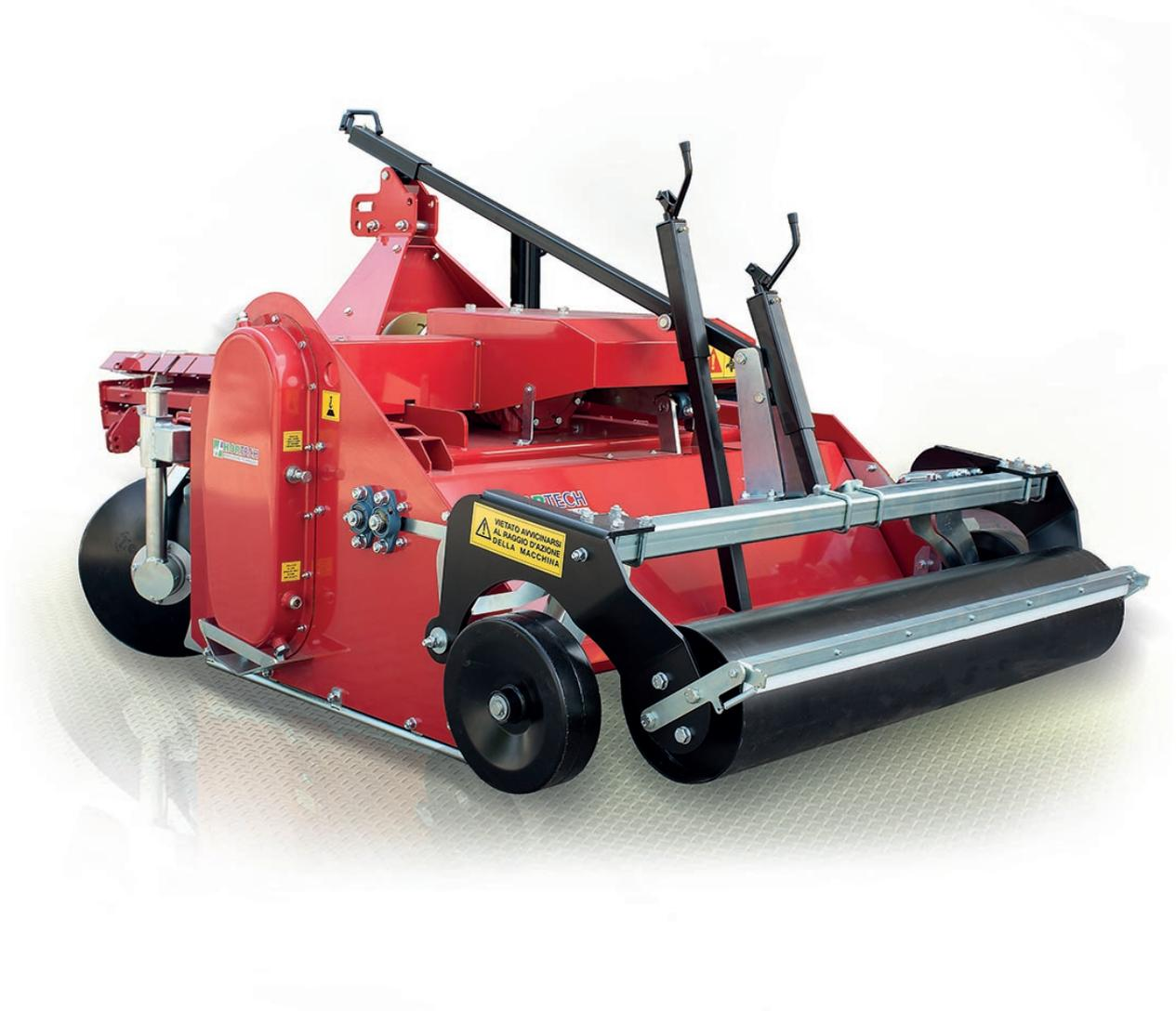
La fraise butteuse - enfouisseur de pierres AI MAXI DG est une excellente solution pour affiner les sols lourds et humides. Elle est munie d'une double grille en acier brevetée; qui pendant le travail se nettoie et permet de enterrer d'une façon progressive les grandes mottes de terre et de obtenir une surface souple, parfaitement nivelé et sans résidu superficiels.
