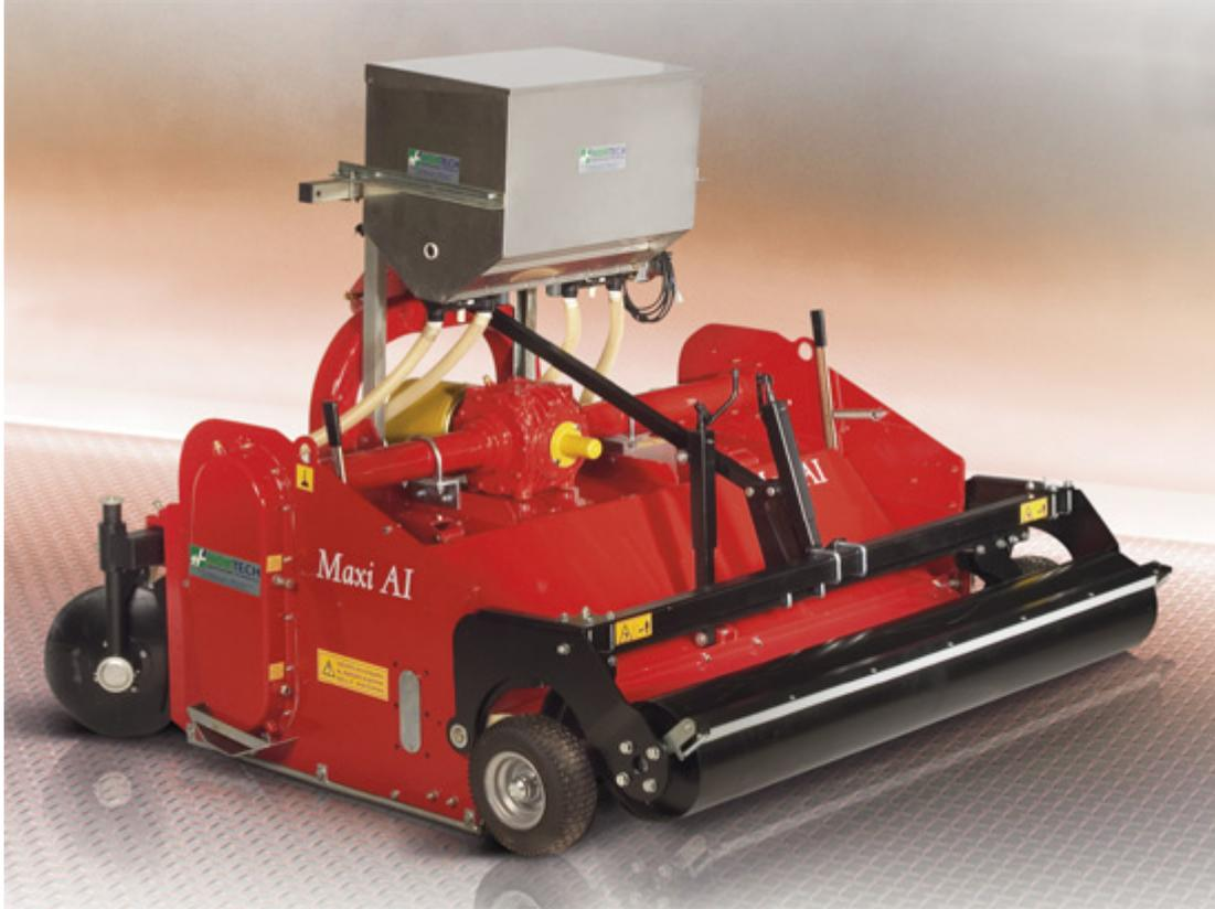
**La fraise - butteuse enfouisseur des pierres mod. AI MAXI** prépare très bien les terrains difficiles, avec des pierres ou des résidus de récolte. AI MAXI est la solution idéale pour travailler soit sur de terrains plats, soit pour former des buttes et elle est utilisée dans le secteur horticole et dans le secteur du jardinage. On peut utiliser au même temps 2 ou 3 machines modèle AI MAXI qui ont été montées sur un châssis pliable modèle AIRONE muni de roues. Puissance du tracteur: 160-180 HP.
