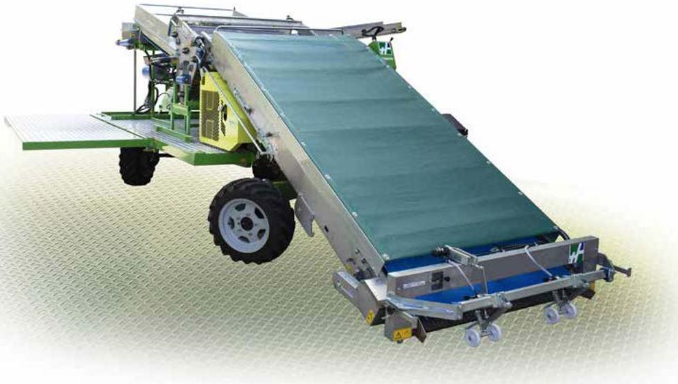
È la raccoglitrice perfetta per la raccolta di valeriana e altri tipi di coltura con radice coltivati in serra o in pieno campo. Ha una capacità di carico di circa 1000/1200 kg. La caratteristica più innovativa, rispetto alla versione base, consiste nel suo sistema idraulico di ultima generazione e in quattro ruote sterzanti che rendono più pratiche le manovre, anche in piccoli spazi.
