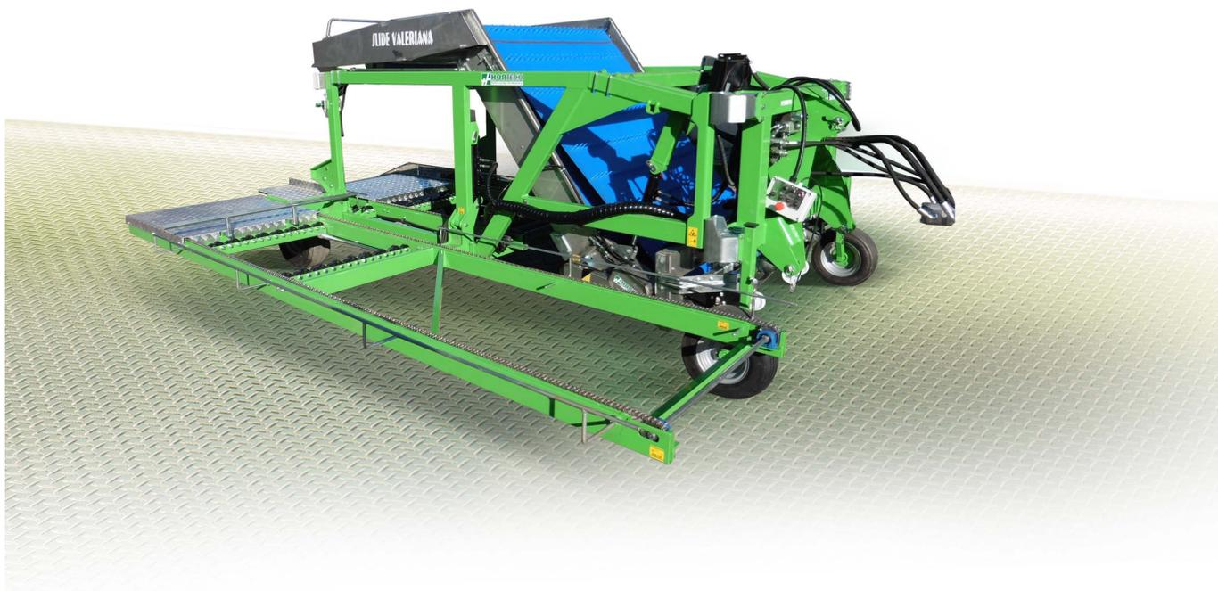
Raccogliatrice trainata portata dal trattore per la raccolta di valeriana con sistema automatizzato per carico e scarico bins a bordo macchina. Tappeto semi verticale con pioli, per garantire la perfetta risalita del prodotto, senza rovinarlo. Sensori elettro-idraulici proporzionali con altezza di taglio regolabile dall'operatore o su richiesta dalla cabina del trattore. Progettata per essere robusta grazie al telaio a traliccio.
