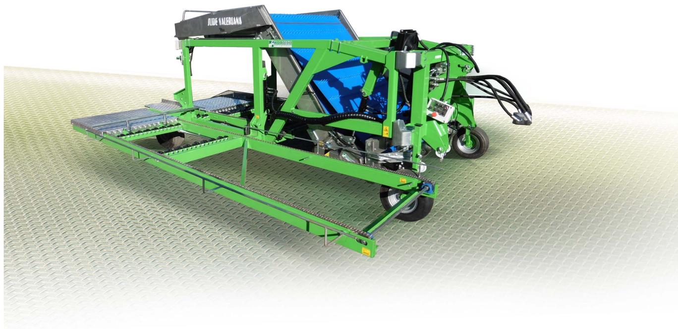
Прицепная машина для уборки листовых салатов с автоматической системой загрузки и выгрузки контейнеров сбоку. Полувертикальная транспортерная лента с прутками обеспечивает отличное перемещение продукта без повреждения. Изменяемая высота среза с пропорциональными электрогидравлическими сенсорами регулируется оператором или, по запросу, из кабины трактора. Решетчатая рама для прочности машины.
