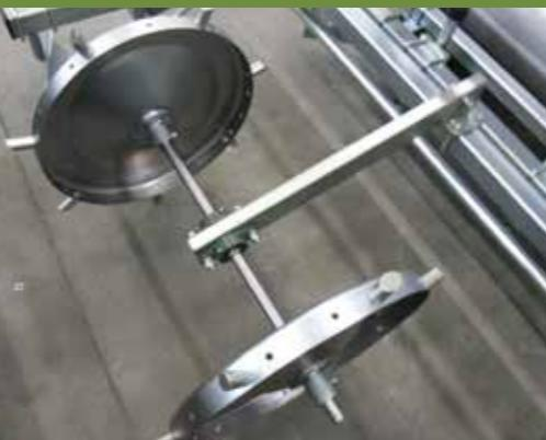
RUOTA FORA FILM • PIERCING WHEEL • RUEDA CON PUNZONES PARA PERFORAR EL FILM • ROUE POUR PERCER LE FILM • LOCHRAD • КОЛЕСО ДЛЯ ПРОБИВКИ ОТВЕРСТИЙ В ПЛЕНКЕ
