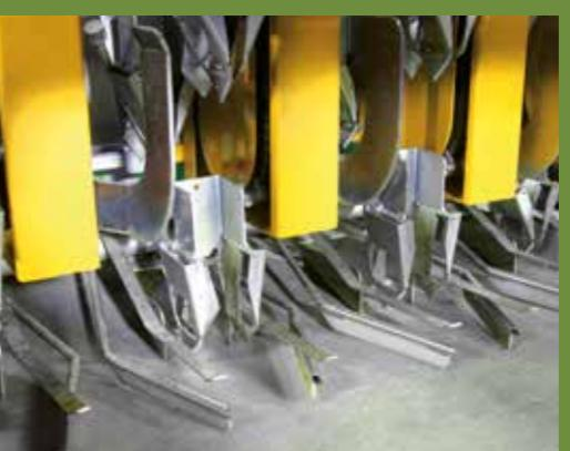
DISTRIBUTORE A TAZZA • CUP DISTRIBUTION SYSTEM • DISTRIBUIDOR A VASOS • SYSTEME POUR PLANTER MUNI DE GODETS • PFLANZSYSTEM MIT BECHERN • СТАКАНЧИКИ ВЫСАЖИВАЮЩЕГО АППАРАТА
