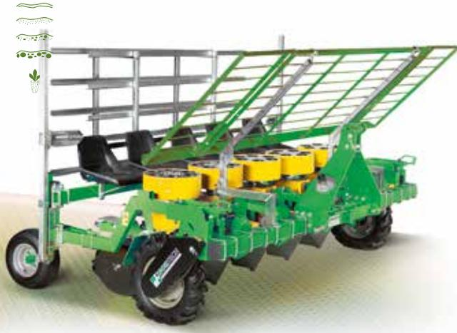
Trapiantatrice dotata di un dispositivo di caricamento a 6 tazze per piantine in pan di terra tronco conici piramidali dal diametro max. di 3 cm. Adatta a lavorare su qualsiasi tipo di terreno.
