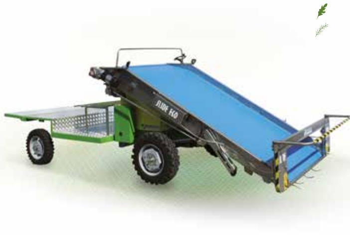
Slide Eco è la raccogliatrice dedicata alle colture orticole per foglie da taglio a motore elettrico che sviluppa una potenza di 30 KW, alimentato da una batteria che consente un'autonomia di 14 ore lavorative.
