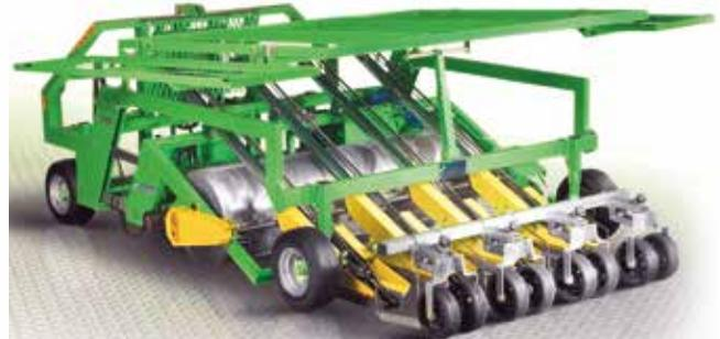
Macchina trapiantatrice la cui peculiarità è la velocità e la precisione della messa a dimora delle piantine in pan di terra cubico grazie al sistema meccanico a doppi nastri. È prodotta sia nella versione trainata dal trattore sia nella versione semovente.
