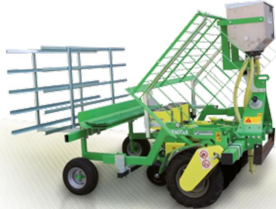
Trapiantatrice modello Practica Midi per piantine in zolle di terra tronco – conico o piramidale. La caratteristica più innovativa consiste nella pulizia automatica del vomere al suo interno. L'elemento di trapianto è di forma rotonda con 8 tazze con movimento a intervalli.
