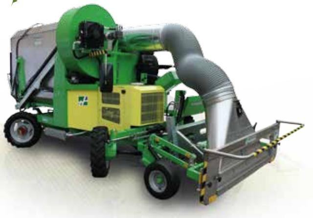
È una macchina potente per l'aspirazione dei residui colturali e delle foglie che restano a terra. Con 4 ruote sterzanti, l'aspiratore è dotato di barra di taglio traslante lateralmente.
