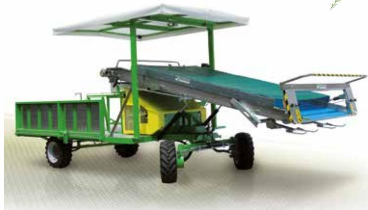
Macchina per la raccolta di prodotti a foglia coltivati in serra o in pieno campo. La caratteristica più innovativa consiste nel suo sistema idraulico di ultima generazione e nella sterzata dell'assale anteriore.
