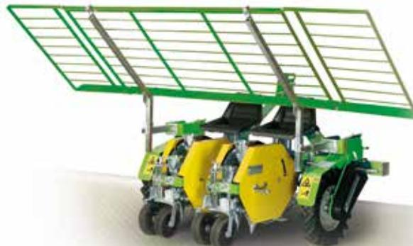
Macchina trapiantatrice estremamente versatile per il trapianto di qualsiasi tipologia di piantina, sia in pan di terra tronco conico piramidale, sia in zolla di forma cubica, e per il trapianto di bulbi e di semi, adatta a lavorare anche su terreni non ben affinati.
