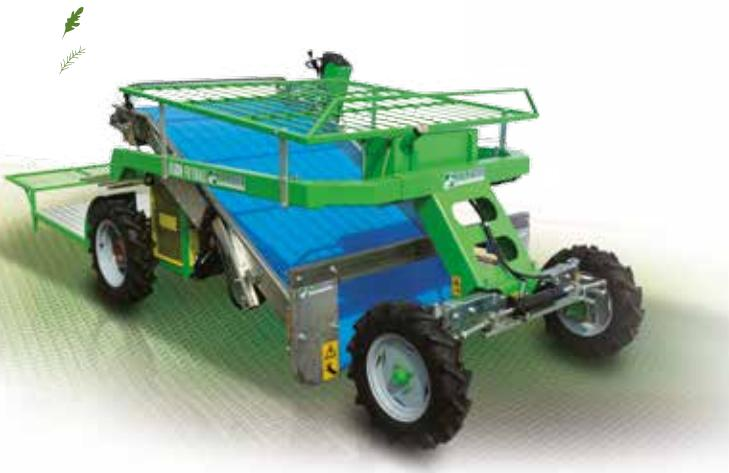
Raccogliatrice semovente per la raccolta di ortaggi a foglia, dalla struttura compatta poiché la barra di taglio è all'interno del telaio e quindi ideale per le piccole serre.
