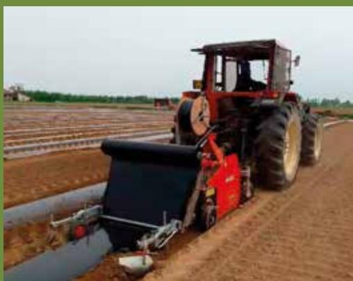
AI MAXI CON KIT PER LA STESURA FILM PACCIMATURA · AI MAXI WITH MULCH SYSTEM LAYER · AI MAXI CON SISTEMA PARA PONER EL FILM DE ACOLCHADO · AI MAXI AVEC SYSTÈME POUR POSER LE PAILLAGE · AI MAXI MIT FOLIENLEGESESYSTEM · ГРЯДООБРАЗОВАТЕЛЬ С ПРИСПОСОБЛЕНИЕМ ДЛЯ МУЛЬЧИРОВАНИЯ ПОЧВЫ ПЛЕНКОЙ
