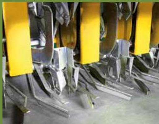
DISTRIBUTORE A TAZZA · CUP DISTRIBUTION SYSTEM · DISTRIBUIDOR A VASOS · SYSTÈME POUR PLANTER MUNI DE GODETS · PFLANZSYSTEM MIT BECHERN · СТАКАНЧИКИ ВЫСАЖИВАЮЩЕГО АППАРАТА
