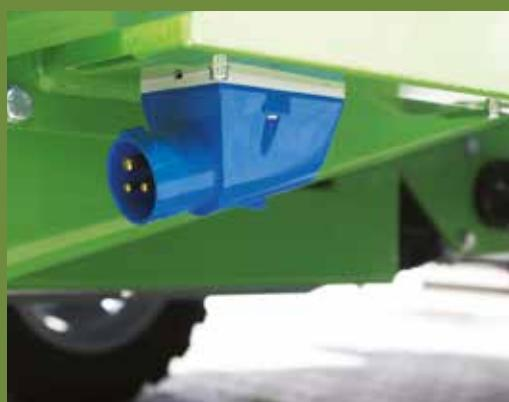
ALIMENTAZIONE PER CARICA BATTERIA • POWER OUTLET TO RECHARGE THE BATTERY • ALIMENTACIÓN PARA CARGAR LA BATERÍA • ALIMENTATION POUR LE RECHARGE DE LA BATTERIE • VERSORGUNGSTECKDOSE ZUM AUFLADEN DER BATTERIE • ПИТАНИЕ ДЛЯ ЗАРЯДА АККУМУЛЯТОРА
