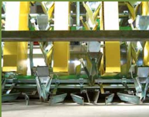
DISTRIBUTORE A TAZZE • CUP DISTRIBUTING SYSTEM • DISTRIBUIDOR A VASOS • СИСТЕМА ПРИВОДА МУНИКИ ПО ГОДЕТС • PFLANZSYSTEM MIT BECHERN • СТАКАННИКИ ВЫСАЖИВАЮЩЕГО АППАРАТА
