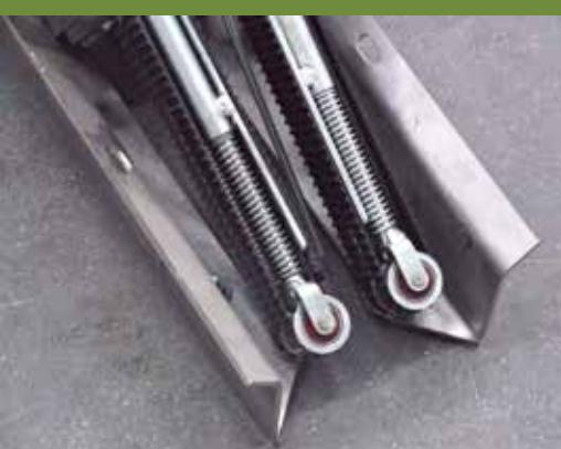
DISTRIBUTORE PIANTINE A DOPPI NASTRI • DISTRIBUTING SYSTEM WITH DOUBLE BELTS • DISTRIBUIDOR PLANTAS CON CINTAS DOBLES • SYSTÈME DE REPIQUAGE AVEC DOUBLE TAPE • PFLANZSYSTEM MIT DOPPELBÄNDERN • СИСТЕМА ПОДАЧИ С ДВОЙНЫМИ ЛЕНТАМИ
