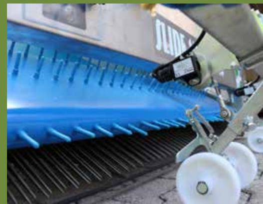
SENSORI DI TAGLIO • CUTTING SENSORS • SENSORES DE CORTE •
