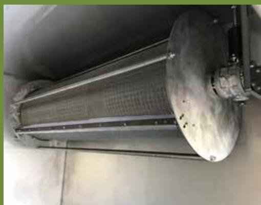
PARTICOLARE PULISCI FILTRO AUTOMATICO • AUTOMATIC FILTER CLEANER • KIT AUTOMATIQUE POUR NETTOYAGE DU FILTRE • KIT AUTOMÁTICO PARA LIMPIAR EL FILTRO • BESONDERES AUTOMATISCHE FILTERREINIGUNG • АВТОМАТИЧЕСКАЯ ОЧИСТКА ФИЛЬТРА
