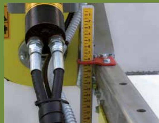
VISUALIZZATORE ALTEZZA DI TAGLIO • VISUALIZER FOR CUTTING HEIGHT • VISUALIZADOR ALTURA DEL CORTE • VISUALISEUR DE L'HAUTEUR DE LA COUPE • SICHTGERÄT FÜR DIE HOHE DES SCHNITTES • ИНДИКАТОР ВЫСОТЫ СРЕЗА
