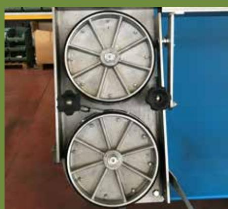
PULEGGE AUTOCENTRANTI PER LAMA TAGLIO • SELF-CENTERING SHEAVES FOR THE CUTTING BLADES • POLEAS CENTRADAS AUTOMÁTICAMENTE PARA CUCHILLA CORTE • POULIES À CENTRAGE AUTOMATIQUE POUR LA LAME DE LA COUPE • SELBSTZENTRIERENDE SCHEIBEN FÜR DAS SÄGEBLATT • САМОЦЕНТРИРУЮЩИЕСЯ РОЛИКИ СРЕЗАЮЩЕЙ ЛЕНТЫ
