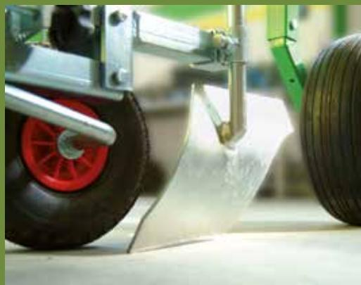
GRUPPO RICALZO FILM • FILM COVERING SYSTEM • GRUPO DE RECALCE DEL FILM • SYSTÈME POUR CHAUSSER • LE FILM • FOLIEANHÄUFELNNS-SYSTEM • СИСТЕМА ДЛЯ ПРИКОПКИ ПЛЕНКИ
