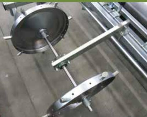
RUOTA FORA FILM • PIERCING WHEEL • RUEDA CON PUNZONES PARA PERFORAR EL FILM • ROUE POUR PERCER LE FILM • LOCHRAD • КОЛЕСО ДЛЯ ПРОБИВКИ ОТВЕРСТИЙ В ПЛЕНКЕ
