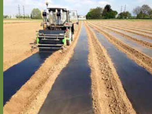
STENDIMANICHETTA AP • PIPE LAYER AP • DISPOSITIVO PARA EXTENDER LA MANGUERA DE GOTEO • POSEUR DE TUYAU AP • TROPSCHLAUCH AP • ПРИСПОСОБЛЕНИЕ ДЛЯ УКЛАДКИ ЛЕНТЫ КАПЕЛЬНОГО ОРОШЕНИЯ
