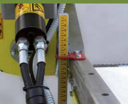
VISUALIZZATORE ALTEZZA DI TAGLIO • VISUALIZER FOR CUTTING HEIGHT • VISUALIZADOR ALTURA DEL CORTE • VISUALISEUR DE L'HAUTEUR DE LA COUPE • SICHTGERÄT FÜR DIE HOHE DES SCHNITTES • ИНДИКАТОР ВЫСОТЫ СРЕЗА
