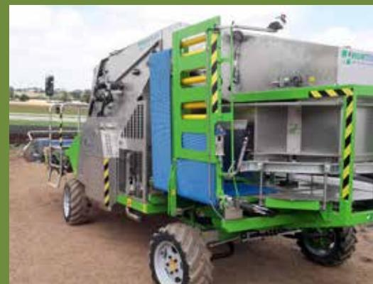
VENTUM 180 CHIUSA IN SAGOMA PER TRASPORTO SU STRADA • CLOSED IN SHAPE FOR ROAD TRANSPORT • FERMÉE EN FORME POUR LE TRANSPORT ROUTIER • CERRADA EN FORMA PARA EL TRANSPORTE POR CARRETERA • GESCHLOSSEN FÜR DEN STRASSENTRANSPORT • ЗАКРЫТОЕ ПОЛОЖЕНИЕ ДЛЯ ТРАНСПОРТИРОВКИ ПО ДОРОГАМ
