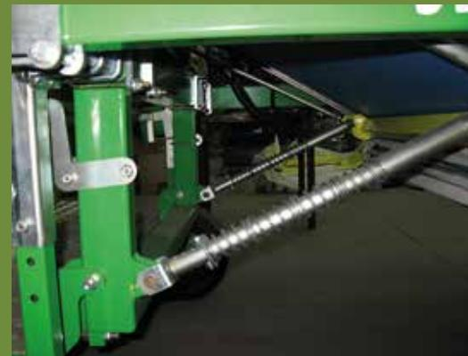
SISTEMA ALLEGGERIMENTO BARRA DI RACCOLTA • LIGHTEN SYSTEM FOR THE HARVESTING BAR • SISTEMA PARA ALIGERAR LA BARRA DE RECOPIDA • SYSTEME POUR DÉLESTER A BAR DE RÉCOLTE • RELIEF - SYSTEM FÜR DIE ERNSTESTANGE • СИСТЕМА ДЛЯ СНЯТИЯ НАГРУЗКИ С УБОРОЧНОЙ ЛЕНТЫ
