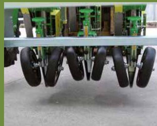
RUOTE COSTIPATRICI • PRESSING WHEELS • RUEDAS COMPACTADORAS • ROUES DE COMPACTAGE • ANDRUCKROLLEN • ПРИКАТЫВАЮЩИЕ КОЛЕСА
