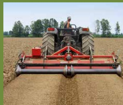
RULLO IDRAULICO PER FORMARE 2 AIUOLE · HYDRAULIC ROLLER TO MAKE 2 BEDS · RODILLO HIDRAULICO PARA FORMAR DOS CAMAS · ROULEAU HYDRAULIQUE POUR 2 BUTTES HYDRAULISCHE WALZE FÜR 2 BEETEN · ПРИКАТЫВАЮЩИЙ ВАЛ С ГИДРОПРИВОДОМ ДЛЯ ФОРМИРОВАНИЯ 2 ГРЯД
