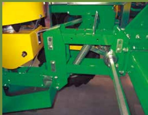
SISTEMA TRAPIANTO A PARALLELOGRAMMA • PARALLELOGRAM TRANSPLANTING SYSTEM • СИСТЕМА ДЕ ТРАСПЛАНТЕ А ПАРАЛЕЛОГРАМОМ • СИСТЕМЕ DE PLANTATION À PARALLÉLOGRAMME • PARALLELOGRAMMPFLANZSYSTEM • ПАРАЛЛЕЛОГРАММИЧЕСКИЙ МЕХАНИЗМ ВЫСАЖИВАЮЩЕГО АППАРАТА
